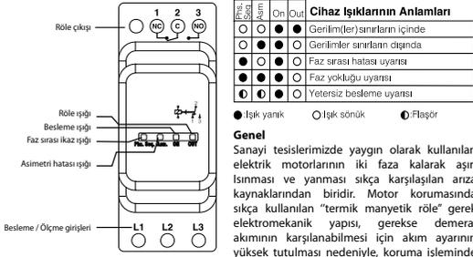
korunması istenilen ekipman; faz hatası, gerilim dengesizliği (asimetri) ve faz sırasının ters bağlanmasına karşı korumak için tasarlanmış MKC-04-U69 motor koruma rölesi aşağıdaki fonksiyonları yerine getirmek için tasarlanmıştır.
